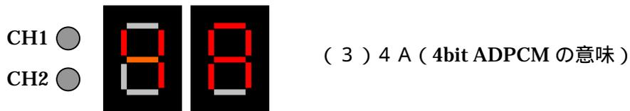
というように、現在設定されている音声合成方式が表示されます。
