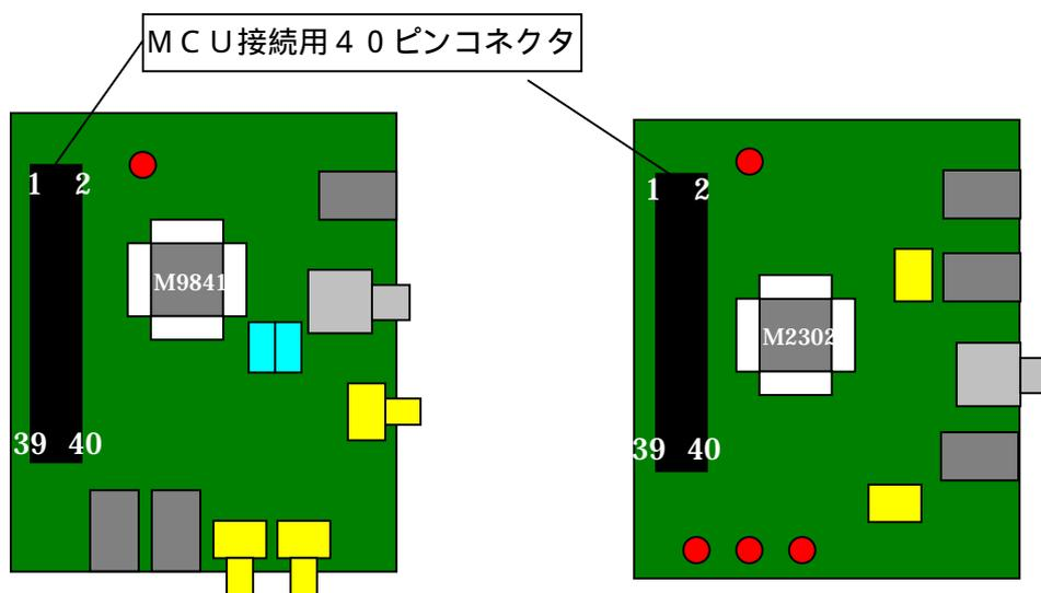
MSM9841 ボード、ML2302 ボード上のMCU接続用40ピンコネクタを外部のターゲットボードと接続することにより、外部からMSM9841 / ML2302 を直接コントロールすることができます。
